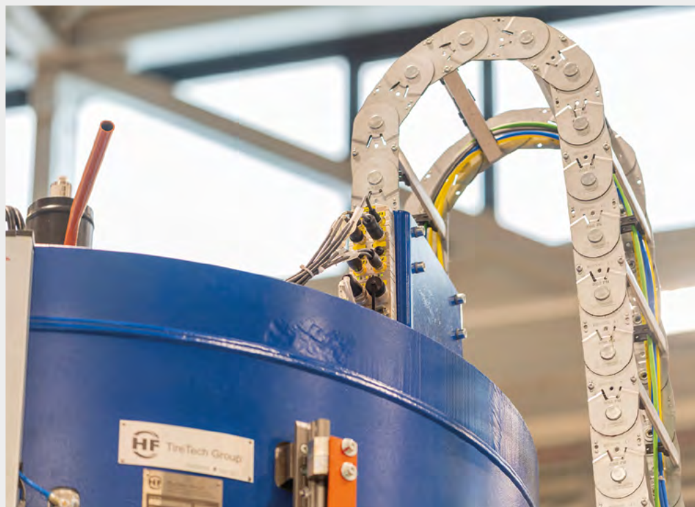
Unità di sicurezza decentralizzata per collegare dispositivi di sicurezza hardware. A decentralized safety unit to connect hardware safety devices.
