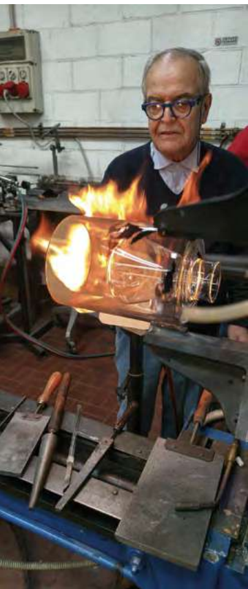
Raffaele Disa mentre realizza una beuta in vetro Pyrex incamiciata su bicchiere soffiato. Raffaele Disa crafting a Pyrex glass flask fitted over a blown glass body.
