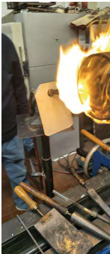
Raffaele Disa mentre realizza una beuta in vetro Pyrex incamiciata su bicchiere soffiato. Raffaele Disa crafting a Pyrex glass flask fitted over a blown glass body.
