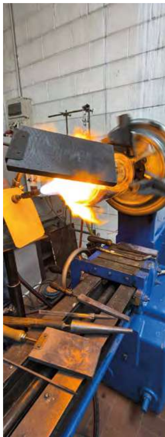
Raffaele Disa mentre realizza una beuta in vetro Pyrex incamiciata su bicchiere soffiato. Raffaele Disa crafting a Pyrex glass flask fitted over a blown glass body.
