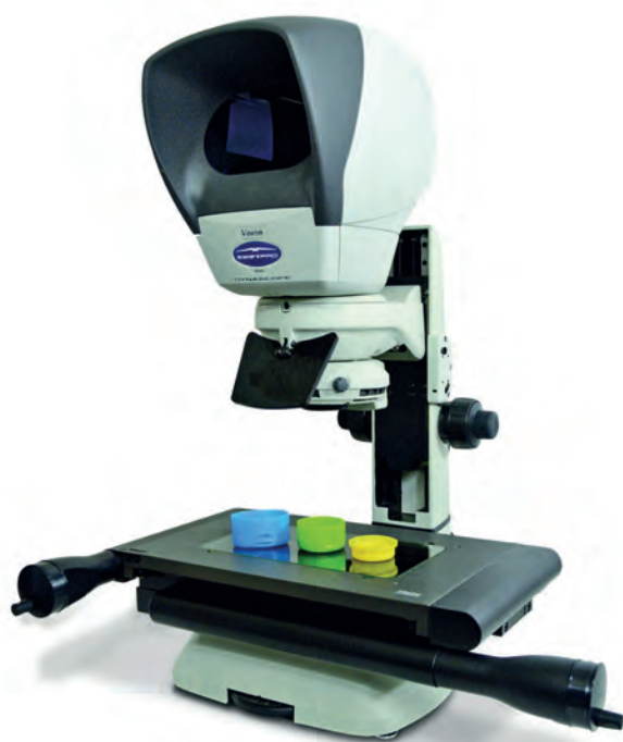
Swift PRO Elite è un microscopio di misura ottico semplice e robusto. Swift PRO Elite is a simple and sturdy optical measuring microscope.
