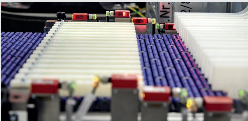
Quando le celle vengono separate, i sensori rilevano la posizione degli oggetti. When the cells are separated, the sensors detect the position of the objects.
