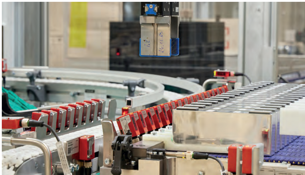
I sensori della serie Leuze 25C rilevano la superficie lucida delle celle in modo affidabile. Leuze 25C series sensors reliably detect the high-gloss surface of cells.
