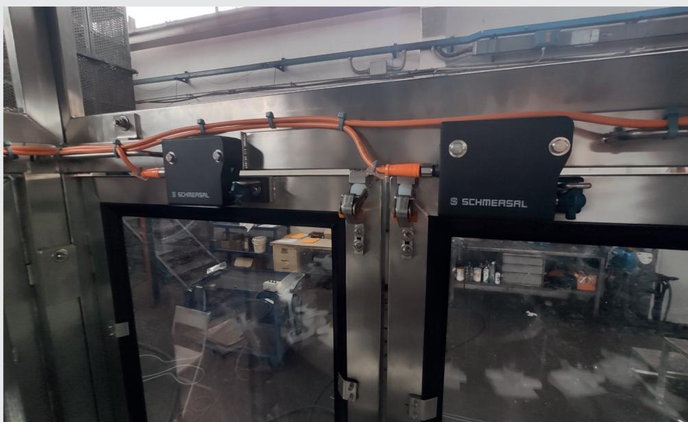
Elettroserrature elettromeccaniche connesse grazie a interfacce universali.
