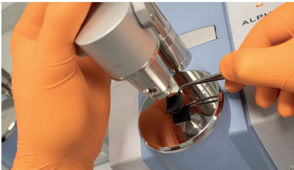
Posizionamento di un campione per misure di spettroscopia IR.
