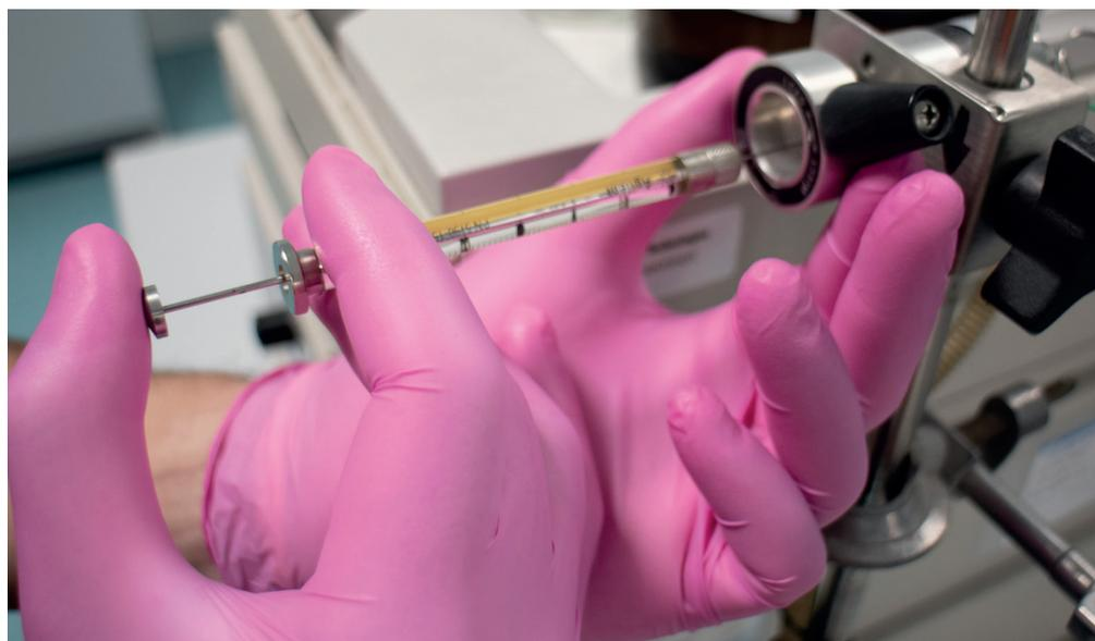
Iniezione di un campione in uno strumento per cromatografia liquida ad alte prestazioni (HPLC).
