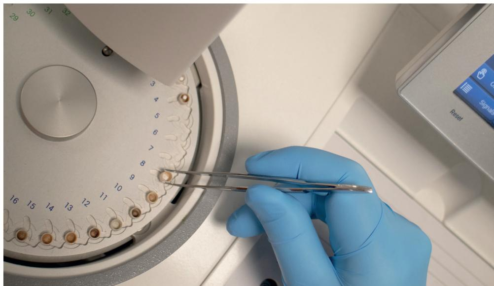
Inserimento di campioni in un caricatore automatico per misure di termogravimetria (TGA).
