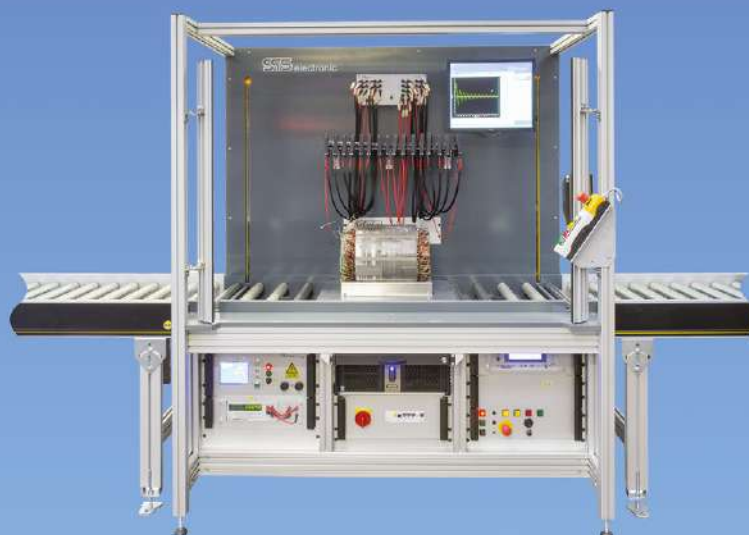
Sistema di collaudo personalizzato per statori e motori elettrici
