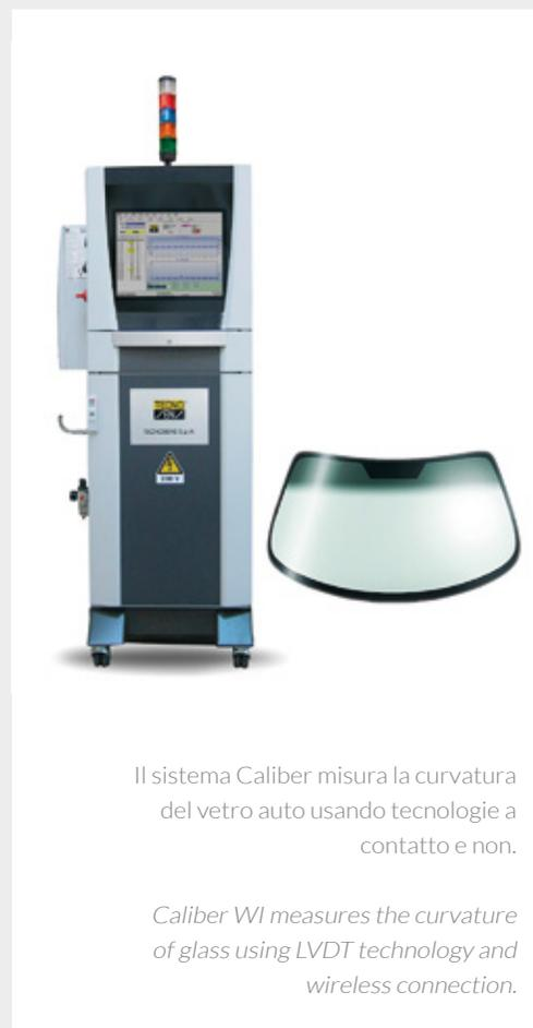
Il sistema Caliber misura la curvatura del vetro auto usando tecnologie a contatto e non.
