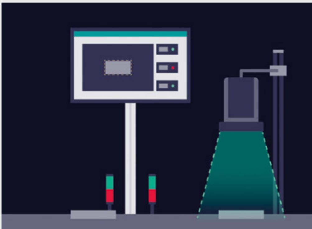
Inspekto ottiene l'immagine e l'esposizione ottimale, rileva l'oggetto nel campo visivo e lo ispeziona. Inspekto obtains the optimal image and exposure, detects the object in the field of view, and inspects it.
