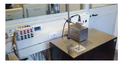
La taratura di temperatura di un forno ad acqua.
